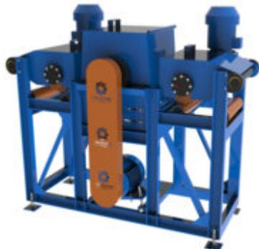
Окорочные станки для горбыля мод. ОС - предназначены для удаления некачественного верхнего слоя древесины (коры) с заготовок лесопиления. В качестве перерабатываемого материала используется древесина в виде горбыля, обзола, необрезной доски. Основными рабочими органами оборудования являются подающий и выгрузной конвейер-рольганг, прижимные рябухи, камера дробления, вал с цепями (коросниматель).
