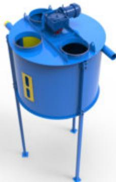
Бункеры-ворошители мод. БВ - являются накопительным элементом в технологических цепочках линий оборудования по производству топливных древесных гранул (пеллет) и кормовых гранул (комбикорма). Бункеры-ворошители способны работать с сухим рассыпчатым материалом, таким как древесина в виде щепы, опила, стружки и т.п., а также с с/х сырьем. Оборудование предназначается для приёма, временного хранения, а также для дальнейшей непрерывной подачи.
