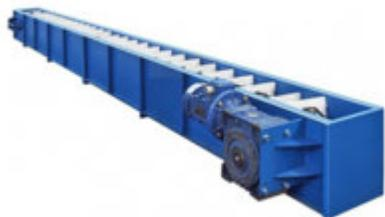
Транспортеры цепные скребковые мод. ТЦС - предназначены для перемещения сухих и влажных сыпучих материалов в горизонтальном направлении и направлении под углом до 45 градусов. Хорошо перемещают зерно, гранулы, щепу, опил, стружку и т.п. Оборудование изготавливается в закрытом и полузакрытом металлическом корпусе, что обеспечивает максимальную пылезащиту и защиту от рассыпания продукта в процессе транспортировки.
