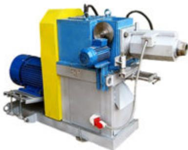
Прессы для брикетов мод. ПБ - предназначены для производства экологически чистых топливных и технологических брикетов евростандарта Pini Kay. Брикеты изготавливаются из отходов лесопромышленного комплекса, предприятий переработки продукции сельского хозяйства без дополнительного ввода связующего.
