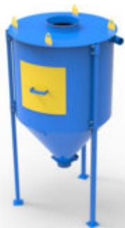
Бункеры-накопители мод. БН - служат для приёма и временного хранения сухих и влажных рассыпчатых материалов. Накопители прекрасно работают с древесными отходами в виде щепы, опила, стружки, пеллет и т.п., а также с с/х сырьем. Основными узлами бункеров являются: накопительная ёмкость разного объёма, загрузочный патрубков, шибберная задвижка.
