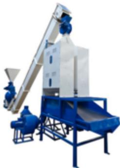
Колонны охлаждения гранул мод. КО - предназначены для охлаждения гранул и отделения несгранулированной части сырья. Основными рабочими элементами являются: загрузочная горловина со шлюзовым затвором, камера охлаждения с вентилятором и аэродинамической трубой, решетчатый стол рассева со встрясывающим механизмом, выгрузная горловина для возврата несгранулированной части и выгрузная горловина для готовой продукции.
