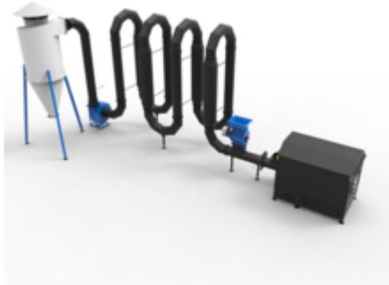
Аэродинамические сушильные агрегат мод. СА - предназначены для подготовки сырья к гранулированию и брикетированию. Оборудование применяется этапе просушки и служит для снижения влажности материала. Процедура просушки происходит в результате перемещения сырья по змеевику вместе с горячим воздухом в аэродинамической трубе. В качестве теплогенератора используется твердотопливный топочный блок, который топится древесиной в любом виде и тем самым снижает затраты на электроэнергию.
