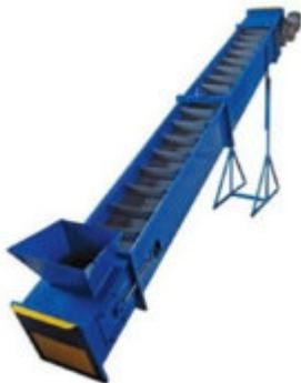
Транспортёры ленточно-скребковые мод. ТЛС - предназначены для перемещения материала в горизонтальном направлении и под углом до 45 градусов. Может быть использован как отдельно, так и в производственных цепочках линии оборудования. При производстве применяются прочные, надежные и износостойкие материалы, что значительно увеличивает срок службы оборудования. Изготавливается как открытого, так и закрытого типа.
